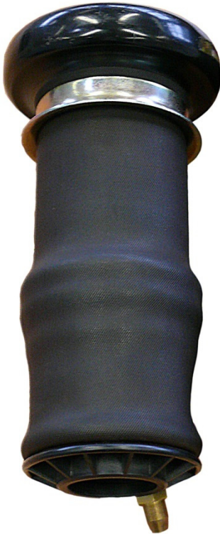
Рис. 1: Замененная пневматическая рессора 557 001
