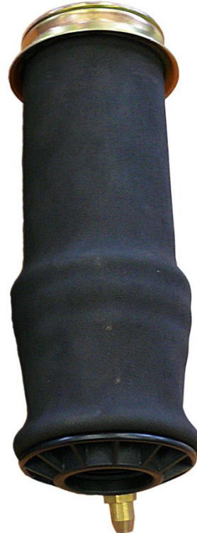
Рис. 2: Устанавливаемая в настоящее время пневматическая рессора 310 619
