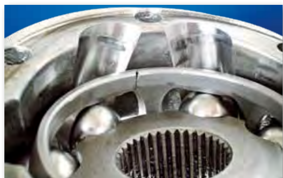
Неисправный шариковый универсальный карданный шарнир
